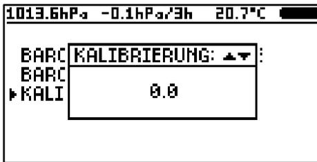
Zum Kalibrieren des Luftdrucksensors wählen Sie bitte den Menüpunkt **KALIBRIERUNG** aus.
